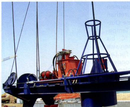
Hydraulische Lastpendeldämpfung an einem RTG-Kran: das Hydraulikaggregat mit Steuerblock und die einfach wirkenden Hydraulikzylinder sind auf dem Spreader installiert
